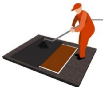
Figura 3 - Corte e remoção do revestimento asfáltico
